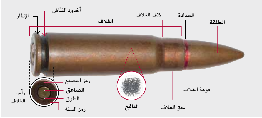
الشكل 4-2: التركيبة الأساسية لخرطوش من عيار 7.26×39 ملم
