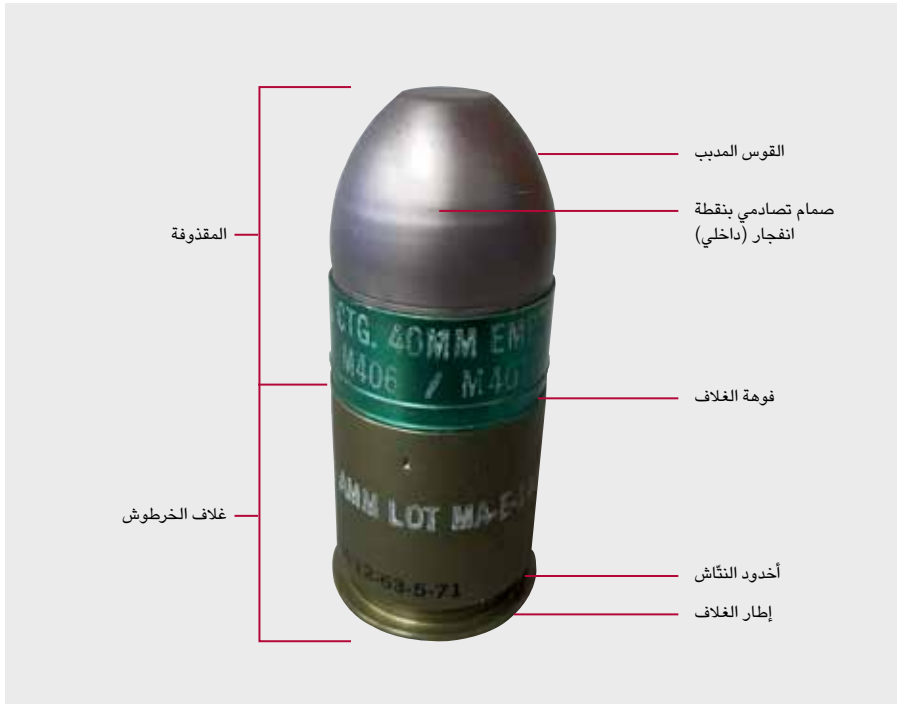
الشكل 5-1: بعض السمات المادية الأساسية لذخيرة قاذفة قنابل
