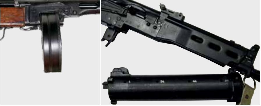
الصورة 3-26: مخزن أسطواني قابل للفصل (يسار) ومخزن أسطواني حلزوني (يمين)
