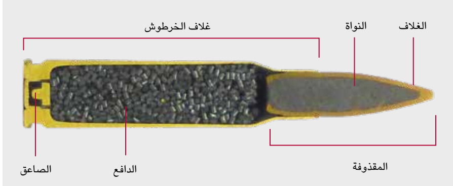
الشكل 4-1: مقطع عرضي لخرطوش من عيار 7.62 \times 51 ملم
