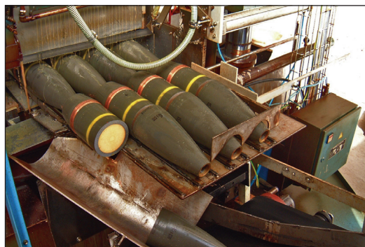
Fotografija (levo): daljinsko uklanjanje udarnog upaljača projektila tokom procesa automatskog rastavljanja, Kirikale, Turska, septembar 2007. © NATO Support Agency
