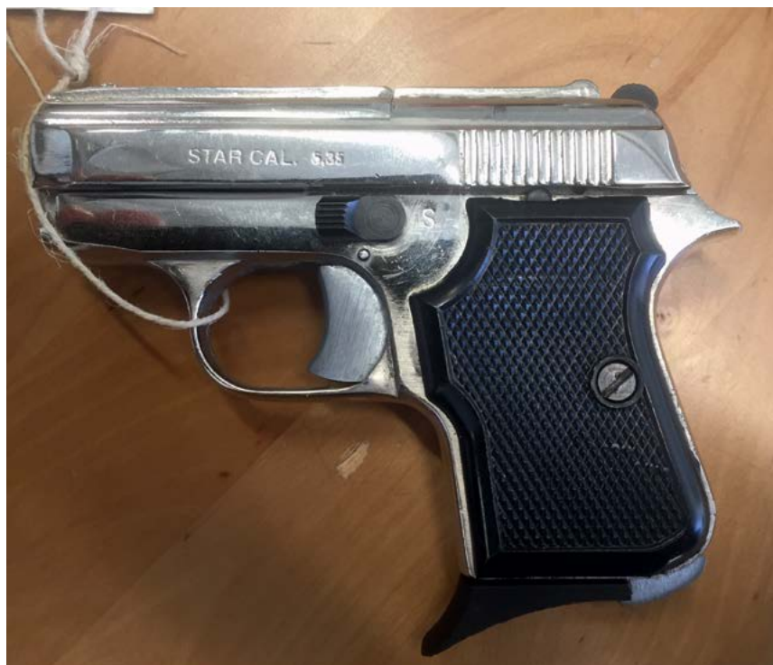
Photographie 1 Réplique d'un pistolet d'alarme Tanfoglio GT 28 converti et doté de faux marquages du fabricant et d'indications relatives au calibre de l'arme après transformation. Photographie prise dans les locaux de la police nationale espagnole à Madrid, le 18 avril 2017. Source : Benjamin King/Small Arms Survey 2017.
