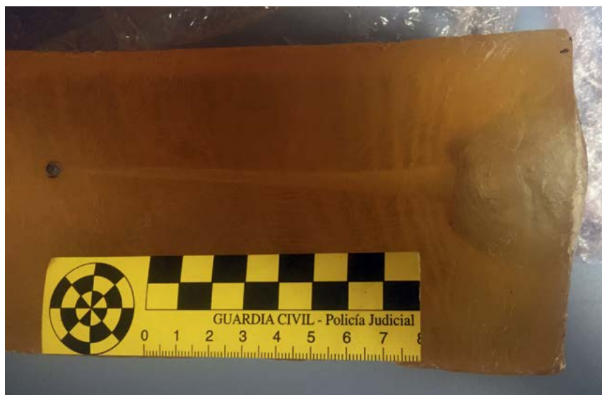
Photographie 4 Tir d'essai d'une bille d'acier introduite dans une munition de calibre 8 mm PAK. Étant donné sa pénétration, le projectile est considéré comme potentiellement létal. Essai réalisé par le département de balistique de la garde civile espagnole. Photographie prise le 19 avril 2017.
