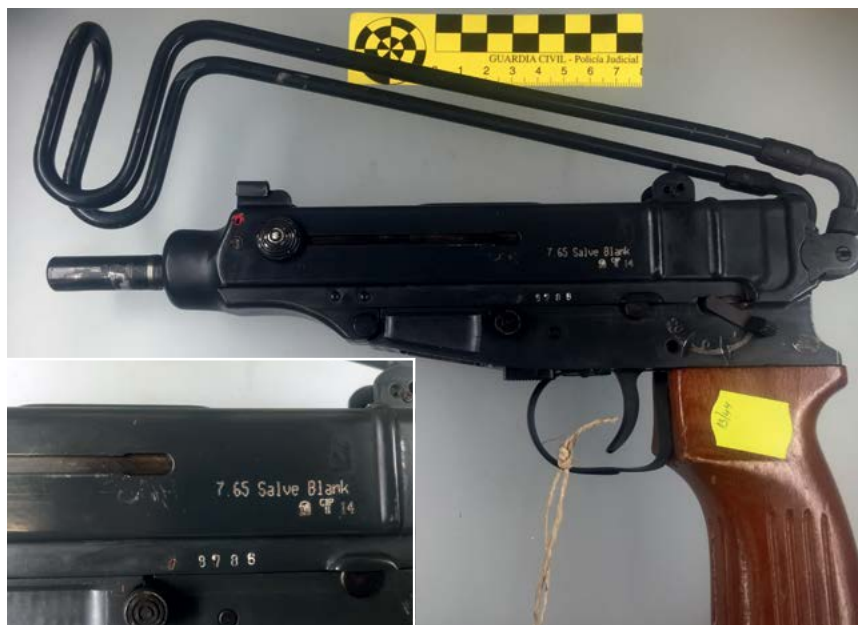
Photographie 3 Des AEW converties saisies par la garde civile espagnole. Les marquages indiquent les nouvelles munitions requises et attestent de la transformation du vz.61 en une AEW à blanc. Photographie prise le 18 avril 2017. Source : Benjamin King/Small Arms Survey
