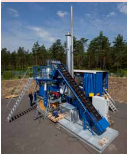
Pokretno postrojenje za demilitarizaciju municije MEA-2, proizvođač Dynasafe Demil Systems AB. © Dynasafe Demil Systems AB/2012
