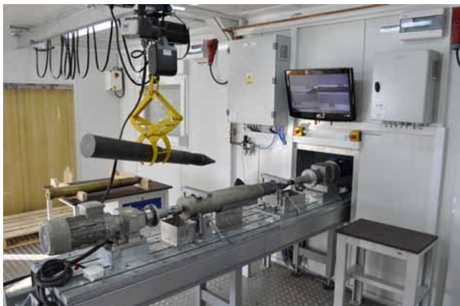
Komponenta prenosivog sistema za rastavljanje municije „JAKUSZ’s Planetarium“, tokom obrade projektila UBK8 od 100 mm. © JAKUSZ SZB/2011
