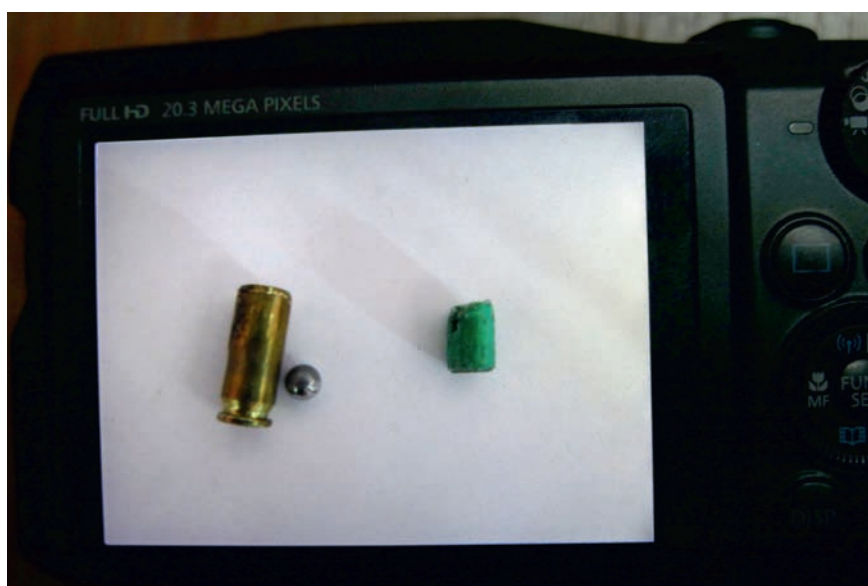
Après tir d'essai d'un pistolet d'alarme Ekol Tuna converti : étui, bille d'acier, obturateur en plastique. Police technique et scientifique (PTS) de Nouakchott, décembre 2017. Source : Service national de la PTS de la Mauritanie
