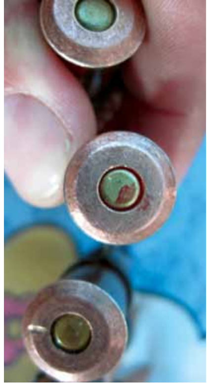
الصورة ١٥٨: ذخائر غير موسومة بظروف فولاذية مطلية بالنحاس عيار ٧,٦٢ × ٥٤ ملم آر استولى عليها الجيش الشعبي لتحرير السودان من فصيل الحركة /الجيش الديمقراطي لجنوب السودان تحت إمرة أتور في مارس/آذار ٢٠١١ في جونتقلي. أبريل/نيسان ٢٠١١. © جونا ليف
