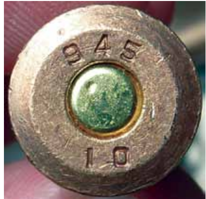
الصورة ٤: خرطوش من المصنع ٩٤٥ عيار ٧,٦٢ × ٥٤ آر ملم منتج في العام ٢٠٠٩ وتم العثور عليه في مغلف سوداني. استولى الجيش الشعبي لتحرير السودان على طلقات من الحركة /الجيش الديمقراطي لجنوب السودان التابعة أنور في مارس/آذار ٢٠١١. جونقلي، جنوب السودان. أبريل/نيسان ٢٠١١. © جون ليف
