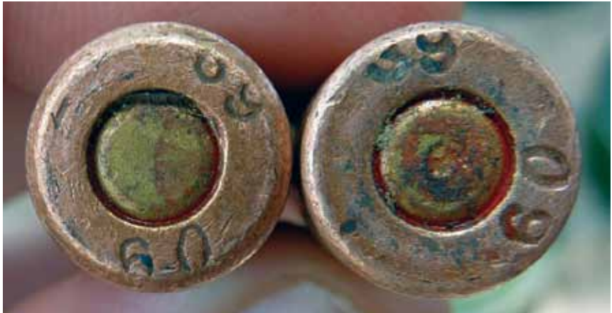
الصورة ٥٩: خراطيش عيار ٦٢، ٧، ٣٩ ملم منتجة في ٢٠٠٩ تحمل أختاما موسومة بصورة سيئة. استولى الجيش الشعبي لتحرير السودان على تلك الذخائر من حركة/جيش تحرير جنوب السودان في أبريل/نيسان ٢٠١١ في الوحدة. © جونا ليف
