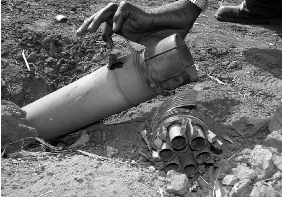
شظايا صواريخ أرض جو من عيار ٨٠ ملم أطلقتها طائرة القوات المسلحة السودانية (SAF) من طراز سوخوي ٢٥ بالقرب من قاعدة الجيش الشعبي لتحرير السودان (SPLA)، في الفرقة، جنوب السودان، فبراير/ شباط ٢٠١١. معلومات سرية ©
