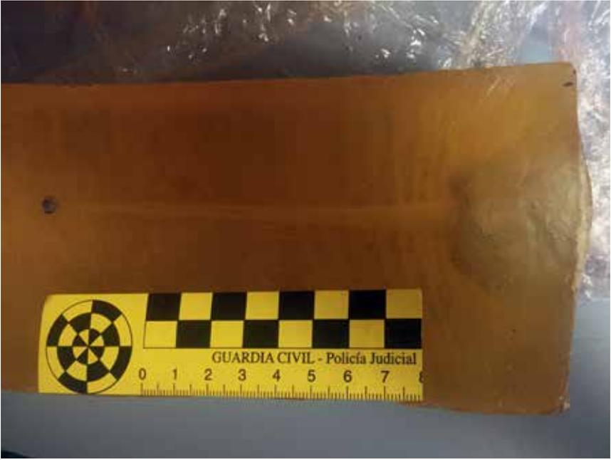
**صورة 4** اختبار تأثير إطلاق محمل كروي مثبت في ذخيرة PAK من عيار 8 ملم. يعتبر اختراق المقذوفة قاتلاً. اختبار أجراه قسم المقذوفات في الحرس المدني. تم التقاط الصورة في 19 أبريل 2017.
