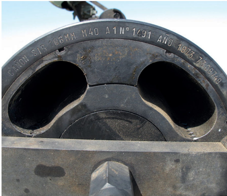
الصورة 5-29: الأوسام على الجزء الخلفي من سلاح عديم الارتداد من طراز M40A1
