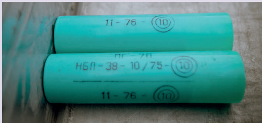
ملاحظة: تشير الأوسام إلى الصانع وتاريخ التصنيع ورقم الشحنة وتفاصيل أخرى المصدر: سري / ARES
